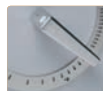
Réglage des cylindres (épaisseur de 0.1 à 34 mm)
