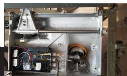
25/ Montage coulisseau, boîtier électrique et poulie
