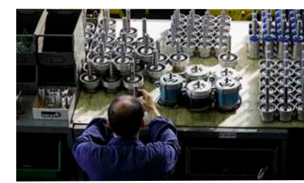
28/ Montage moteur et poulie
