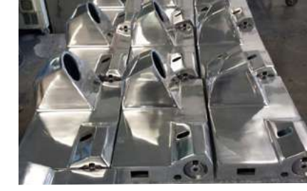
17/ Polissage bâti TG 350 façon miroir avant anodisation
