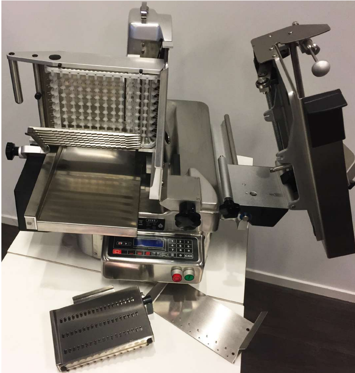
Chariot basculant avec pousse talon extractible
