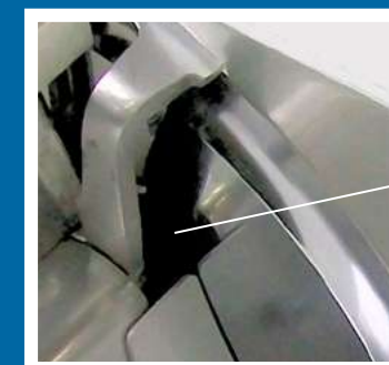
Soufflet de protection autour de la poulie
