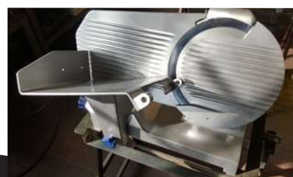
26/ Montage butée, lame, pare-lame et chariot
