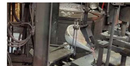
4/ remplissage du moule avec l'aluminium en fusion
