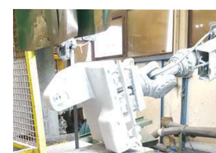
11/ Robot scieur pour élimination des couronnes de surplus
