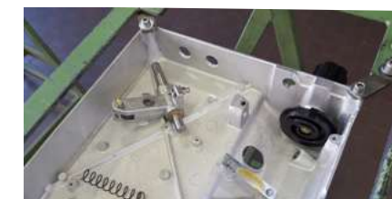
23/ commencement du montage sur table rotative
