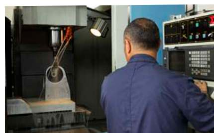
12/ Usinage des bâtis et de l'ensemble des pièces avant polissage et anodisation
