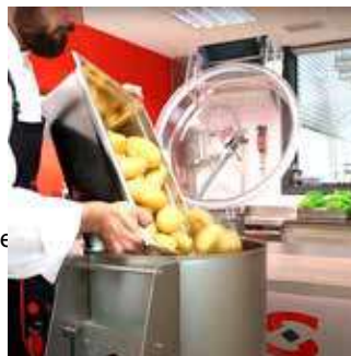
2-en-1 Éplucheuse +essoreuse.
