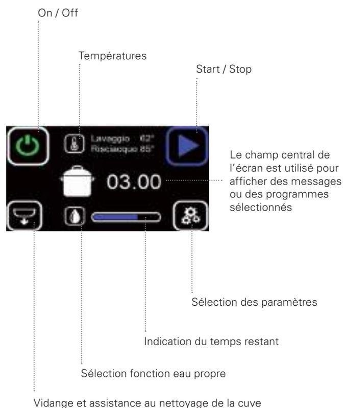
**SYSTÈME DE RINÇAGE À HAUTE TEMPÉRATURE (HTR)**
